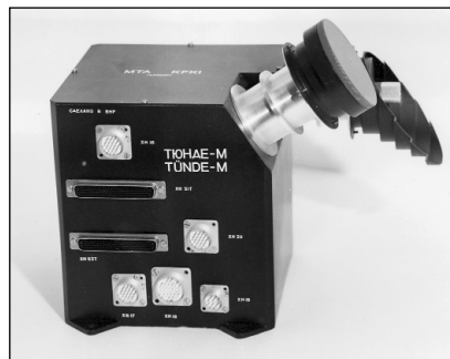
A VEGA űrszondához tervezett részecske-detektor
